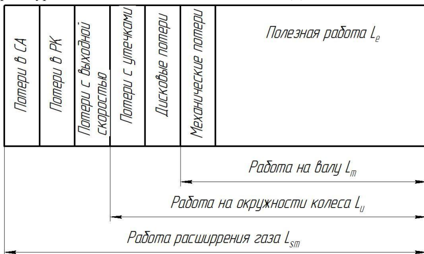
Рис. 1.7. Диаграмма баланса энергии в ступени турбины
