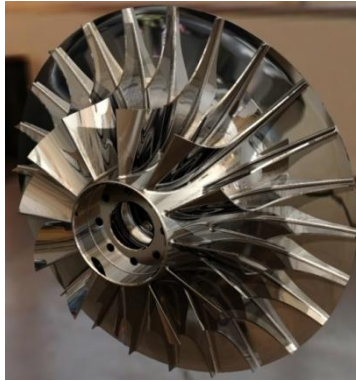
Рис. 1.5. Внешний вид рабочего колеса центробежного компрессора. (Обратите внимание на форму лопаток и то, что они являются единым целым с диском)
