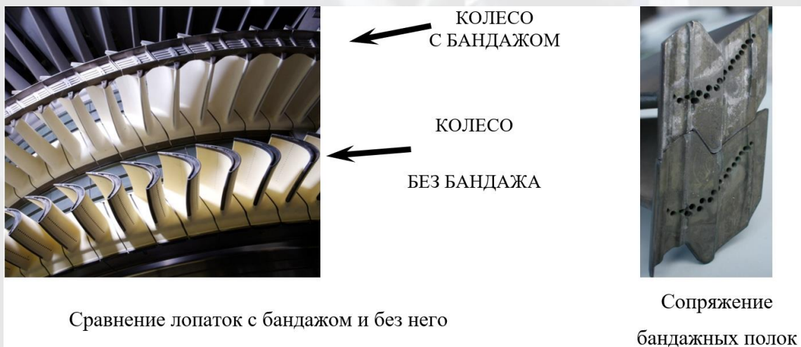
Рисунок 2.11 - Рабочие лопатки осевой турбины с бандажной полкой и без нее [8]
