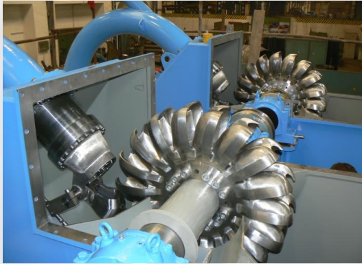
Рисунок 1.4.22 – Турбина Пельтона с горизонтальным расположением оси вращения [8]
