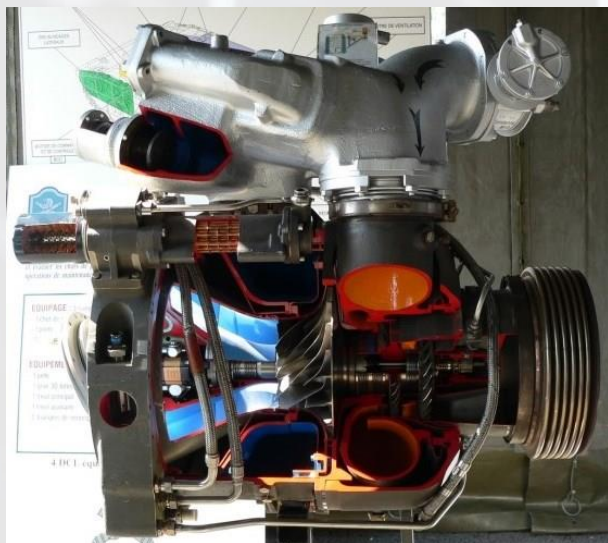
Рисунок 3.34 – Турбокомпрессор с камерой сгорания системы «Гипербар» [8]
