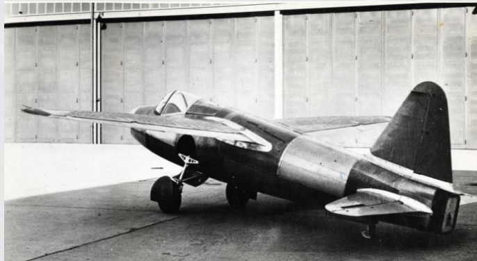
Рисунок 3.52 - Опытный самолет Хейнкель He-178 с турбореактивным двигателем Охайна Heinkel HeS 3b
