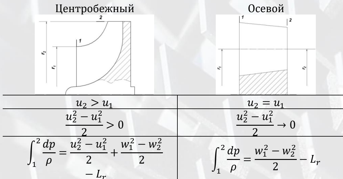
Рисунок 7.7 – Сравнение осевого и центробежного компрессоров
