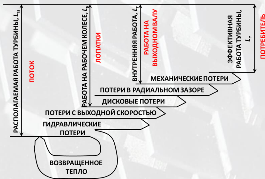
Рисунок 11.9 – Баланс энергии в ступени турбины
